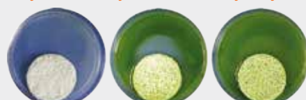
Rast plesní na bežných silikónových omietkach iných výrobcov
