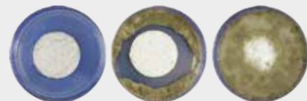
Rast plesní na bežných silikónových omietkach iných výrobcov
