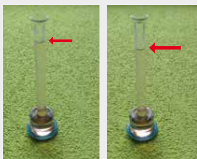
Skúška nasiakavosti na bežných silikónových omietkach iných výrobcov
