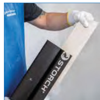
Snadná výměna čepele bez použití nářadí díky velkým upínacím pojistkám pro hladký průběh práce.
